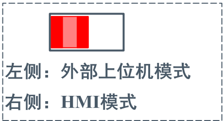
图 12 在外部上位机模式下，拨位开关SS3/4和SS5/6的位置
