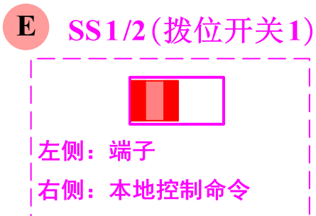
图 3 端子控制下，拨位开关SS1/2位置
