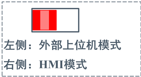
图 7 在外部上位机模式下，拨位开关SS3/4和SS5/6的位置
