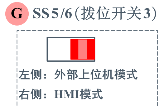
图 6 在HMI模式下，拨位开关SS3/4和SS5/6的位置
